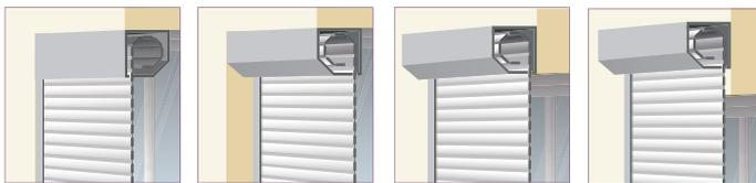
Sous linteau, enroulement intérieur
