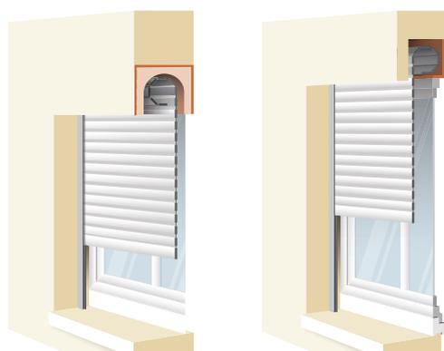
Avec coffre tunnel intégré dans la maçonnerie
